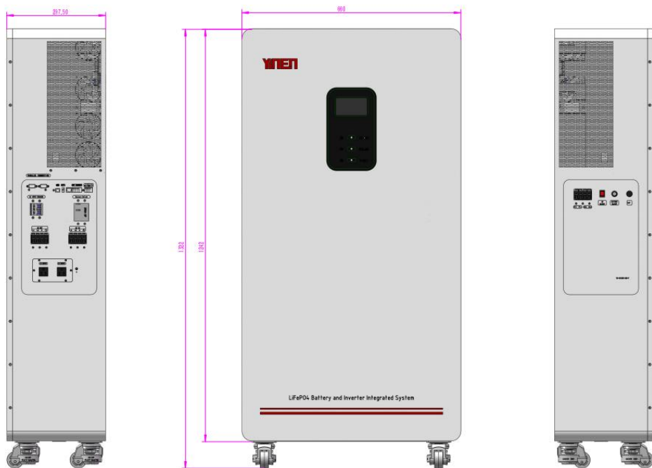
图 11-3：型号 YN-48120S-20-Y 尺寸图
