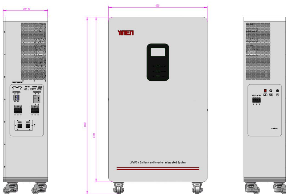
图 11-2：型号 YN-48120S-16-Y 尺寸图
